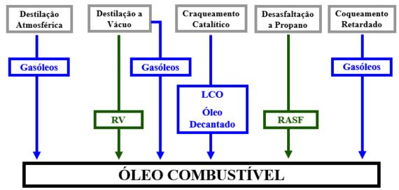
Figura 2 - Exemplo de esquema de produção do óleo combustível.
